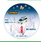
※全国に配置された国土地理 院電子基準点をネットワーク化 してGPS補正(FKP方式)を行っ ています。補正方式として広範 囲を均一に誤差補正できるFKP 方式を採用しています。
